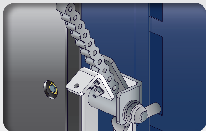
DISPOSITIF PERMETTANT L'ARRÊT DU CHARIOT EN CAS DE CHUTE ACCIDENTELLE. DISPOSITIVO DE PARADA DEL CARRO EN CASO DE CAÍDA ACCIDENTAL.
